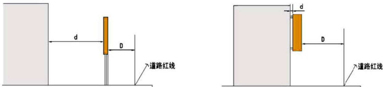
图12.1-5 户外广告设施与建筑外立面的距离(d)、与道路红线的距离(D)
